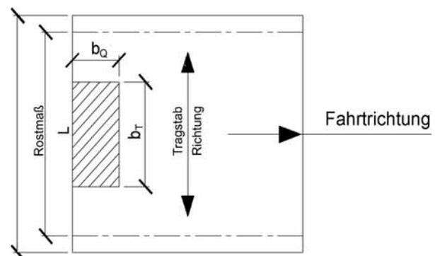
Bild 1 – Schweißpressroste (Lastordnung 1)
