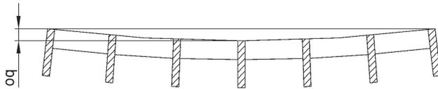
Abweichung für konkav  $o_q$  max. =  $\frac{1}{200}$  der Breite bei Abmessungen > 600 mm: max. 8 mm; kleinere Abmessungen als 600 mm: max. 3 mm
