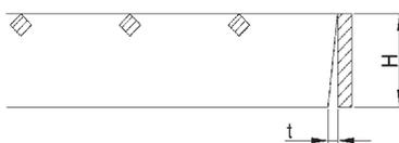
Schrägschnitt des Trag- und Querstabes t max. =  $\pm 0,1 \cdot H$ , jedoch max. 3 mm
