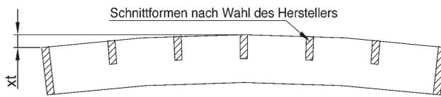
Abweichung für konvex  $x_t$  max. =  $\frac{1}{200}$  der Länge bei Abmessungen > 600 mm: max. 8 mm; kleinere Abmessungen als 600 mm: max. 3 mm
