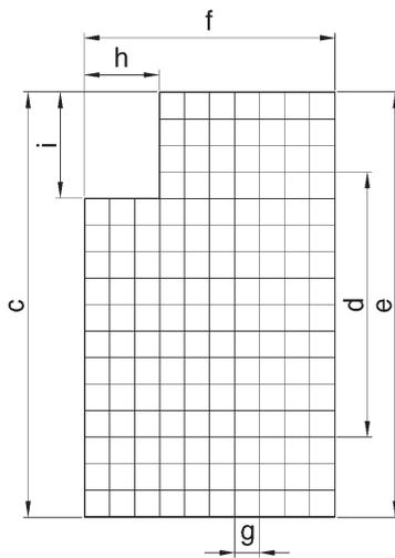
$c; e; f = \max. \begin{matrix} +0 \\ -4 \end{matrix} \text{ mm}$ ;  $g = \max. \pm 1,5 \text{ mm}$   $d = \max. \pm 4 \text{ mm}$  (über 10 Teilungen gemessen)  $h; i = \begin{matrix} +8 \\ -0 \end{matrix} \text{ mm}$
