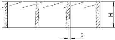
Schrägstellung der Trag- und Randstäbe p max. =  $0,1 \cdot H$ , jedoch max. 3 mm
