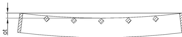
Abweichung für konkav  $ot \text{ max.} = \frac{1}{200}$  der Länge bei Abmessungen > 600 mm: max. 8 mm; kleinere Abmessungen als 600 mm: max. 3 mm
